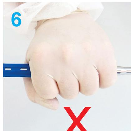
6 Ao posicionar a mão na parte metálica da chave, haverá o travamento do dispositivo interno e conseqüentemente a soltura do parafuso.
