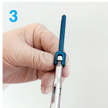
3 Rosqueie o dispositivo interno da chave de introdução na cabeça do parafuso para a inserção.
