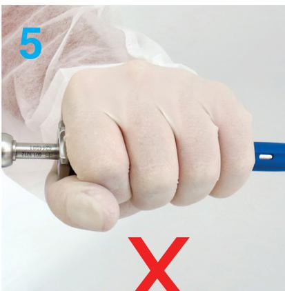
5 Ao posicionar a mão na parte metálica da chave, haverá o travamento do dispositivo interno e conseqüentemente a soltura do parafuso.
