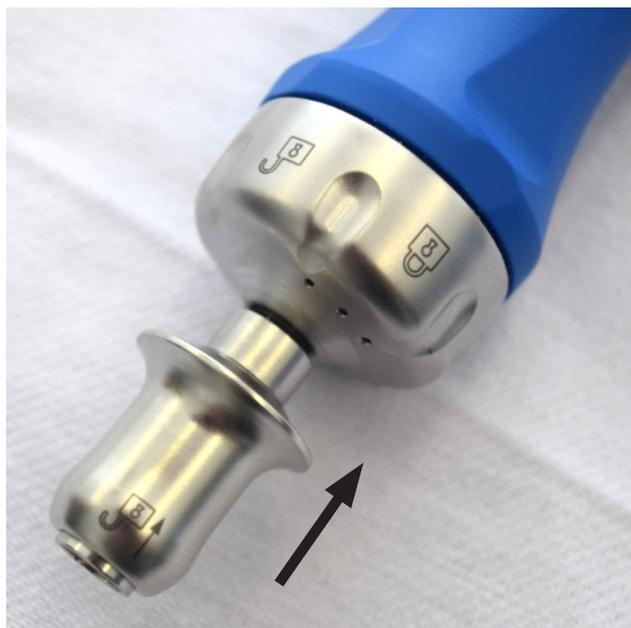
Puxar o sistema de engate tipo rápido no sentido indicado pela seta e, em seguida, inserir o instrumental na região de encaixe.
